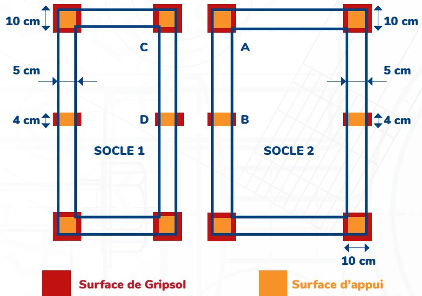
En divisant le poids total de la machine : 1940 kg par le total des surfaces d'appui : 388 cm<sup>2</sup>, on obtient le chiffre 5 correspondant à la pression au cm<sup>2</sup> désirée. Si le centre de gravité de la machine est très éloigné du centre de gravité du polygone obtenu en joignant les points d'appui, on essaiera de déterminer la marge réelle en chaque point pour vérifier que la pression ne dépasse en aucun cas 25 kg/cm<sup>2</sup>
