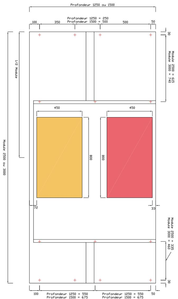
Les points de suspension sont indiqués sur le schéma par le symbole  $\oplus$  laissés à l'appréciation lors du montage.
