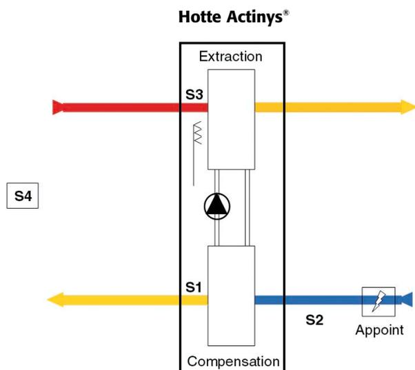
En fonction des températures mesurées par les différentes sondes, le régulateur enverra l'ordre de mise en route de la pompe de circulation ou non de sorte que la température de soufflage corresponde à la température de consigne.
